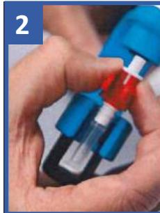
**2.** S'assurer que l'anneau de rétention sur la pince est ouvert (morceau noir du bas sur l'image; si fermé, le tourner) et insérer le tube de prélèvement comme illustré.
