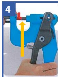
**4.** En plaçant le tube s'il n'est pas enligné avec le piston, serrer la pince jusqu'à ce que le piston soit accoté sur le socle blanc de la lame (flèche jaune sur l'image).
